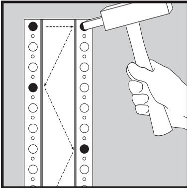
Coloque los lados alternos a intervalos de 8", manteniendo el canal de revelado recto y a nivel.
