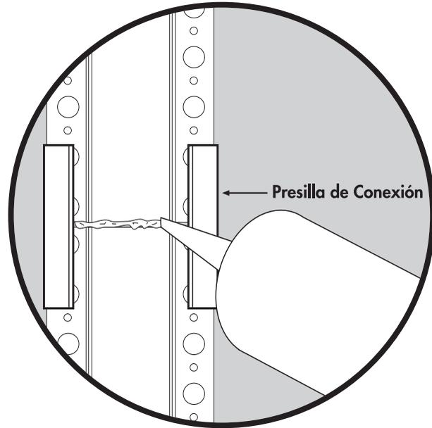
Para aplicación continua (horizontal o vertical). Utilice una presilla de conexión para unir los extremos. Aplique una capa de calafateado en la junta. Retire el exceso de calafateado con un paño limpio. Todas las superficies deben estar libres de aceite, polvo y cualquier otro material extraño. Limpie con agua y jabón solamente.
